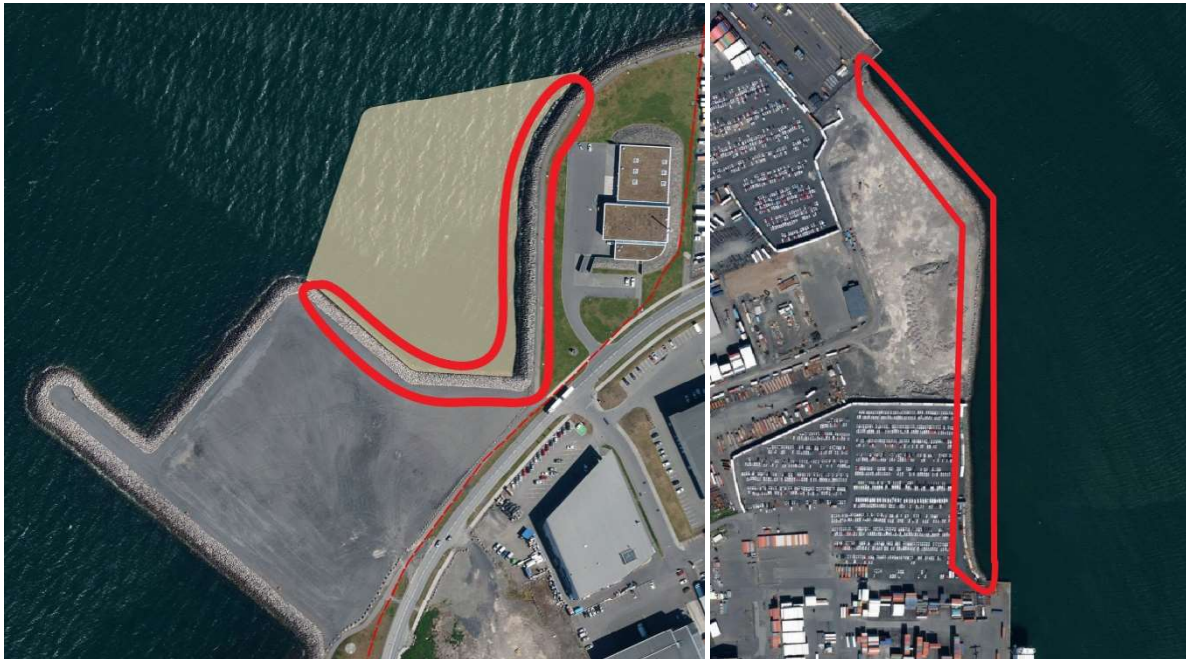
MYND 3.11 Hér er búið að merkja inn þá grjótvörn sem hægt er að endurnýta, annars vegar við Klettagarða (t.v.) og hins vegar milli Sundabakka og Vogabakka (t.h.).
